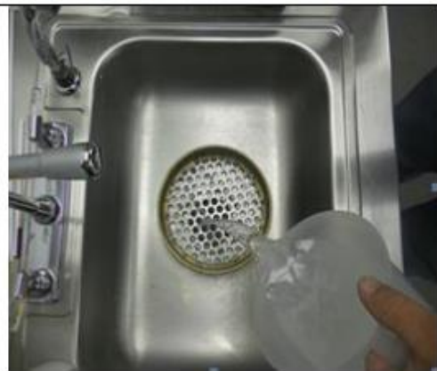
5. ピッチャーの内容物を 12.5mm のふるいに注ぎます。 注意： 排水管の真上にふるいを置きます。
